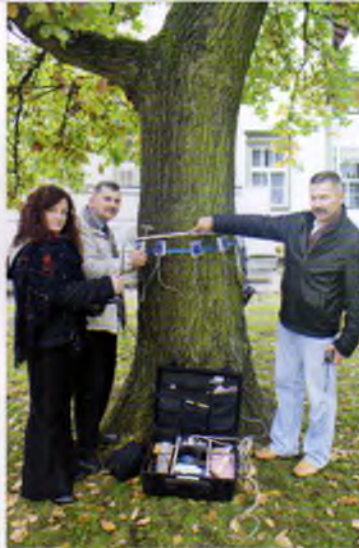
J. Barons ar speciālistiem veic koka dendrotomogrāfiju, nosakot kokam veselības stāvokli ar skaņu viļņu palīdzību.
